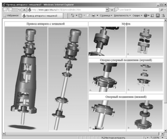
Рис. 3. Меню элементов привода
