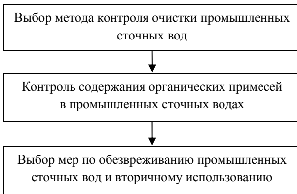
Рис. 1. Алгоритм мероприятий для разработки рекомендаций по обезвреживанию и вторичному использованию промышленных сточных вод
