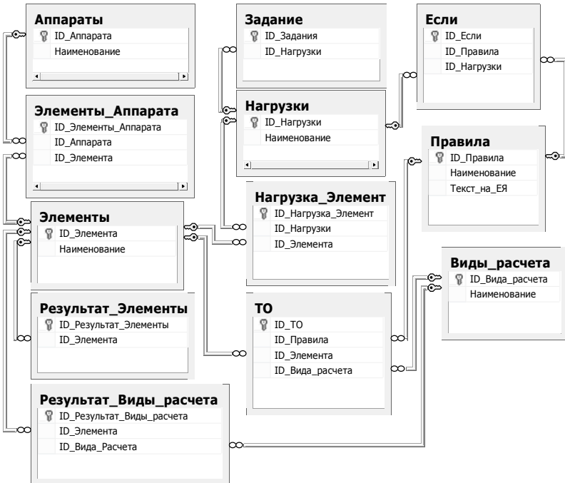
Рис. 4. Схема базы данных определения элементов, подлежащих расчету, и видов расчетов
