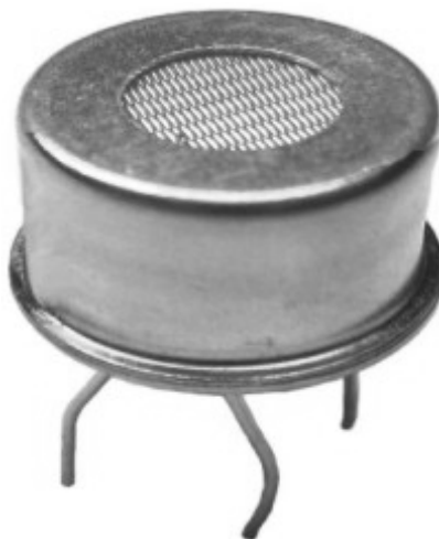
Рис. 3.22. Полупроводниковые химические датчики (газовая фаза)
