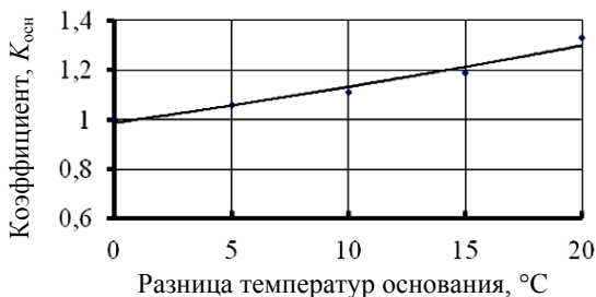
Рис. 4.7. Зависимость K_{осн} от разницы температур основания и воздуха
