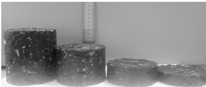
Рис. 2.11. Образцы ЦМА для определения влияния толщины слоя одежды на прочностные параметры
