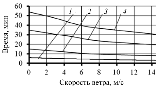
Рис. 5.6. Влияние скорости ветра на продолжительность охлаждения горячей смеси в заданном температурном интервале: 1 – толщина слоя 0,03 м; 2 – 0,05 м; 3 – 0,08 м; 4 – 0,10 м
