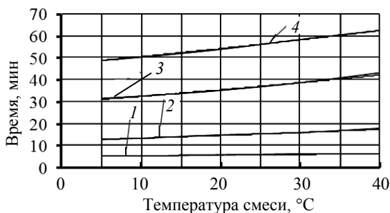
Рис. 5.5. Зависимость времени охлаждения слоя от температуры воздуха для смесей типа А и Б на битумах марок БНД 40/60, 60/90, 90/130 при разной толщине слоя покрытия
