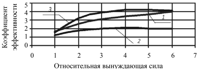
Рис. 6.7. Зависимость коэффициента эффективности вибрационного катка от относительной вынуждающей силы:
