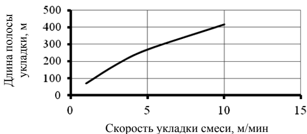
Рис. 5.54. Зависимость длины захватки при укладке от рабочей скорости асфальтоукладчика
