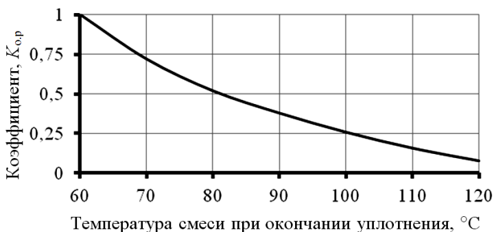
Рис. 6.5. Зависимость коэффициента окончания уплотнения смеси от температуры окончания работы
