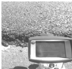
Рис. 3.21. Съемка тепловизионной камерой температуры асфальтобетона при устройстве покрытия
