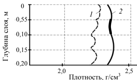
Рис. 1.3. Распределение плотности асфальтобетона по толщине слоя:
