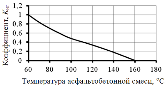
Рис. 5.64. Влияние нижней температурной границы производства работ на продолжительность нахождения горячей смеси в заданном температурном интервале
