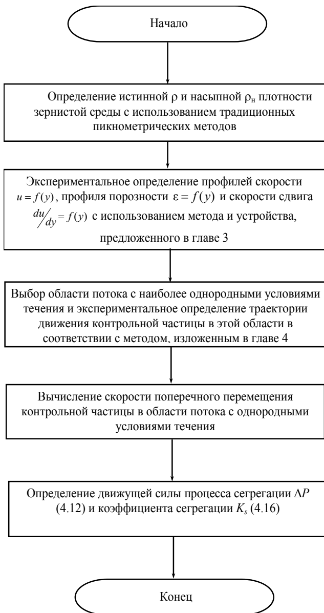
Рис. 4.13. Блок-схема алгоритма определения коэффициента сегрегации
