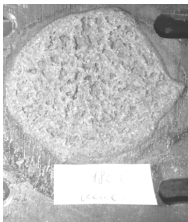
Рис. 1.17. Сухой слой, жесткие режимы (увеличение \times 50 )
