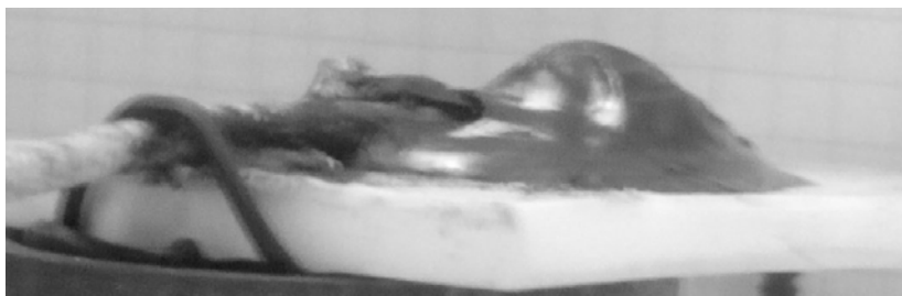
Рис. 1.14. Фото сухого слоя пластификатора с зафиксированным подъемом поверхности (конец сушки)
