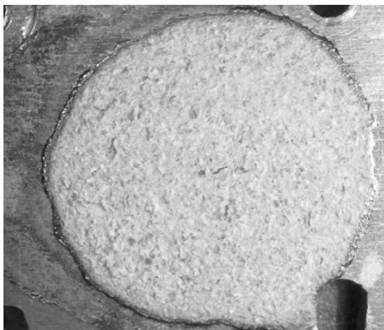
Рис. 1.16. Сухой слой, мягкие режимы (увеличение \times 50 )
