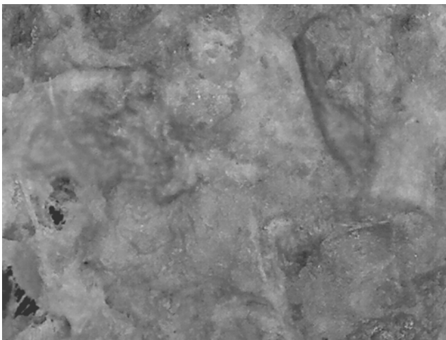
Рис. 1.22. Фотография с микроскопа – поверхность остатка кукурузной барды (мягкие режимы, увеличение \times 50 )
