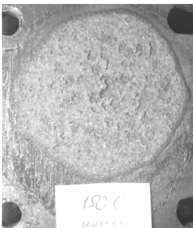
Рис. 1.17. Сухой слой, жесткие режимы (увеличение \times 50 )
