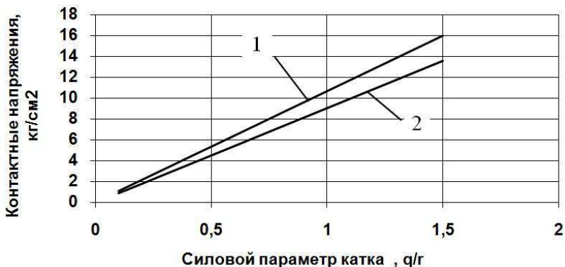
Рис. 8.7. Зависимость контактных напряжений под ведущим вальцом катка от силового параметра q/r ( q – линейное давление, кН/м; r – радиус вальца, м): 1 – напряжения сжатия; 2 – касательные напряжения
