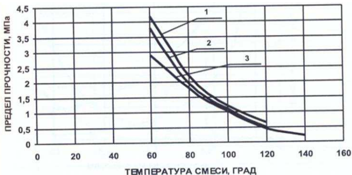
Рис. 2.5. Влияние температуры смеси на предел прочности при сжатии: 1 – смеси типа А – 56% щебня; 2 – смеси типа В – 25% щебня; 3 – по данным [28]
