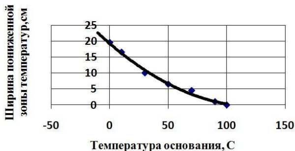
Рис. 9.20. Влияние температуры нагрева основания от ширины зоны асфальтобетона пониженной температурой (асфальтобетон типа В; битум марки БНД 90/130; температура смеси при укладке +120 °С; температура воздуха 0 °С; скорость ветра 0 м/с)
