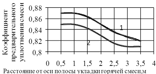
Рис. 5.10. Распределение коэффициента K_{\text{пред}} горячей смеси по ширине укладки слоя горячей асфальтобетонной смеси: 1 – скорость укладки 1,4 м/мин; 2 – 2,0 м/мин (температура воздуха 15 и 22 °С, толщина слоя укладки 0,09 м)
