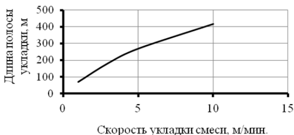
Рис. 6.37. Зависимость длины захватки от рабочей скорости асфальтоукладчика при укладке
