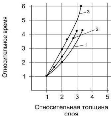
Рис. 7.13. Влияние относительной толщины уплотняемого слоя на время уплотнения:
