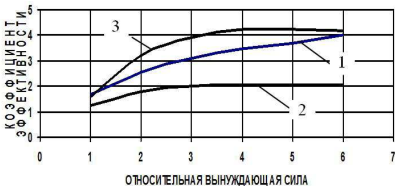
Рис. 8.9. Зависимость коэффициента эффективности вибрационного катка от относительной вынуждающей силы:
