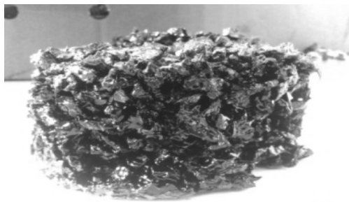
Рис. 2.3. Структура уложенного слоя материала после заполнения выбоины инъекционно-струйным методом
