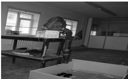
Рис. 2.10. Установка Husqvarna производительностью 780 м 3 /ч с устройством боковой загрузки материала на шланге
