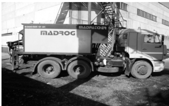
Рис. 1.6. Дорожный ремонтер MADPATCHER MP 6,5 WD
