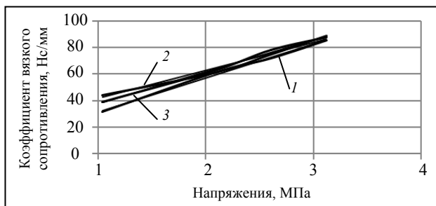
Рис. 2.22. Зависимость коэффициента вязкого сопротивления смеси от напряжения при разной толщине слоя смеси: 1 – толщина слоя 0,03 м; 2 – 0,05 м; 3 – 0,07 м
