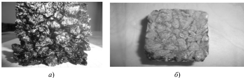
Рис. 6.1. Внешний вид образцов в выбоине дорожного покрытия, отобранного в производственных условиях:
