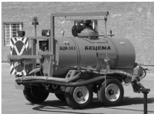
Рис. 1.4. Оборудование на прицепе для ямочного ремонта дорожных покрытий (БЦМ-24.3)
