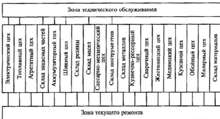
Рис. 3.9. Структурная схема комплектования цехов и их связи с производственными зонами
