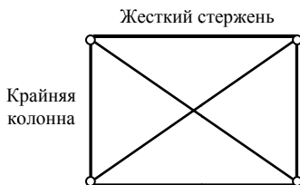
Рис. Модель двухмерной фермы стены-диафрагмы
