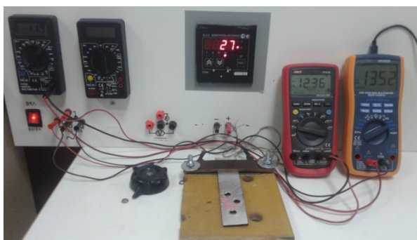
Рис. 3. Автоматизированный стенд для исследования Smart-нагревателей.
