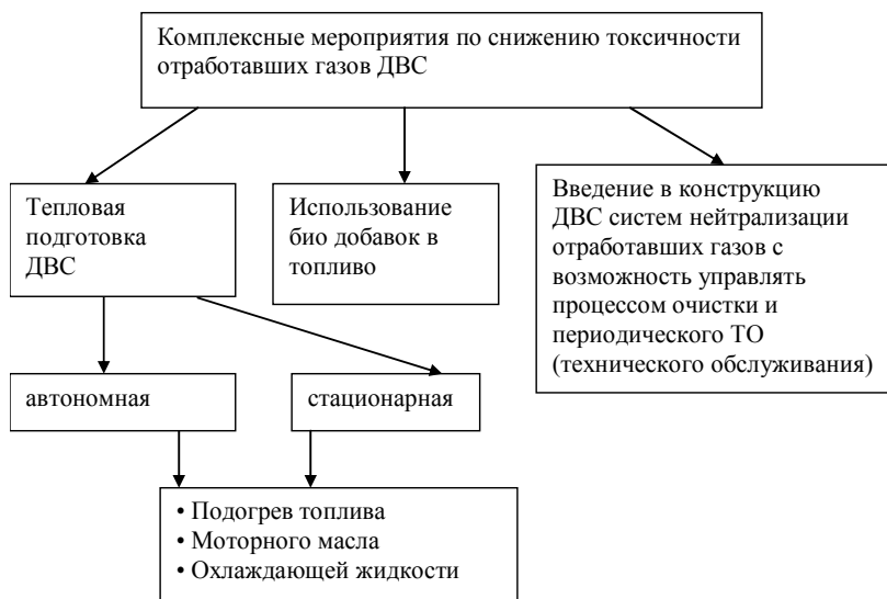
Рис. 1. Схема мероприятий по нейтрализации отработавших газов двигателей внутреннего сгорания.
