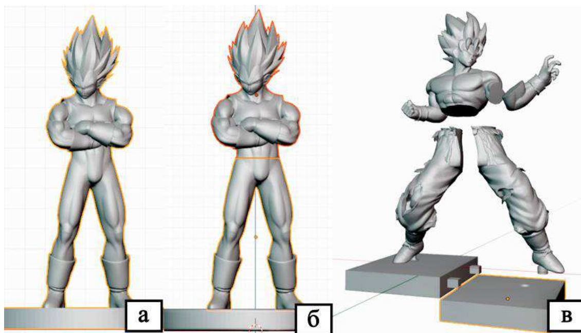
Рис. 2. Разделение модели на части: а) оригинал; б) разделение на 2 части; в) пример разделения
