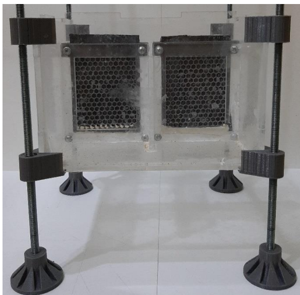
Рисунок 1. Общий вид трехкамерной электродиффузионной установки.
