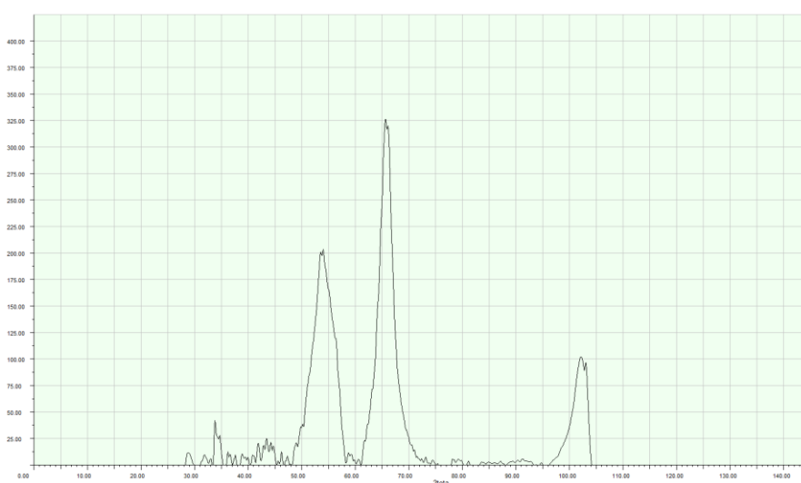
Рисунок 2. Рентгенограмма катализатора Fe-Co(MgO-Al 2 O 3 ), синтезированного при 500 °С.
