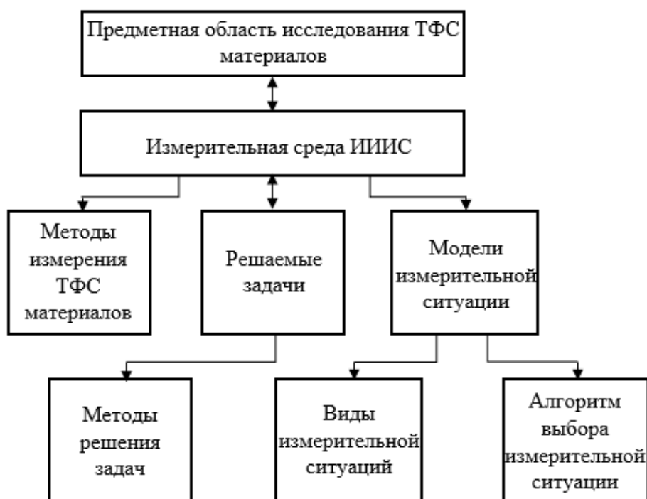
Рис. 1. Концептуальная модель формирования измерительной среды ИИИС для определения теплофизических свойств материалов
