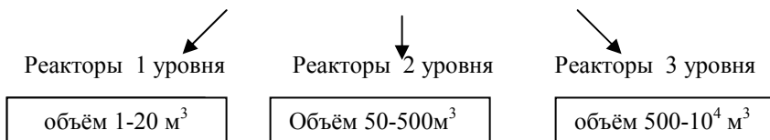
Рис. 1. Классификация установок для получения биогаза
