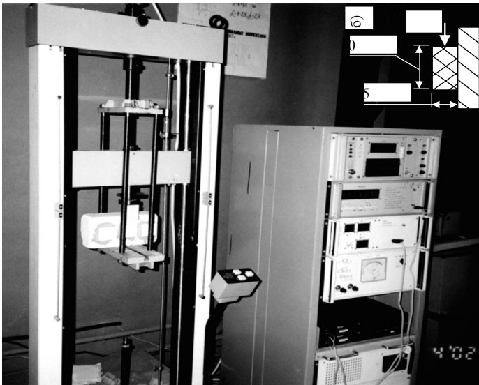
Рис. 1. Определение адгезии цокольной плитки и прочности соединений с ней (а); схема нагружения образца (б)
