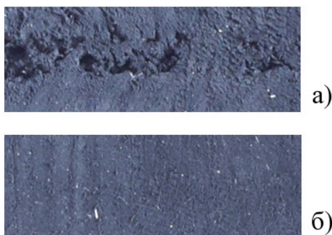
Рис. 3. Фотографии поперечных сечений переработанной резиновой крошки без воздействия ультразвука (а) и с его применением (б)
