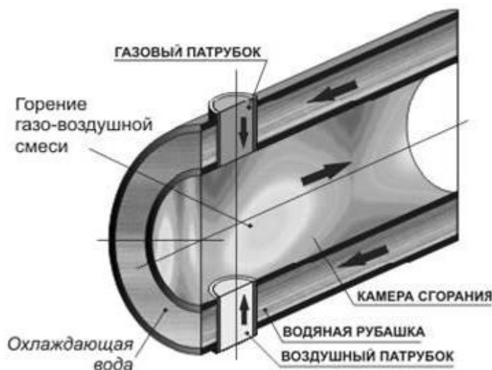
Рис. 1. Схема камеры сгорания водогрейного котла на основе аппарата пульсирующего горения
