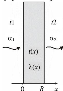
Температурное поле неограниченной пластины (рис. 1) описывается решением следующей задачи теплопроводности:
