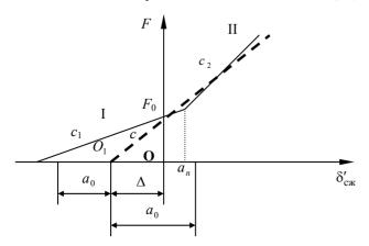
полуфабриката между валами, действующее на торцевую грань винтового ножа;  $a_0$  – амплитуда относительных колебаний валов;  $\Delta$  – смещение центра колебаний, обусловленное предварительным сжатием полуфабриката между валами и несимметричностью его упругой характеристики; F – кусочно-линейная функция, аппроксимирующая характеристику упругости.
