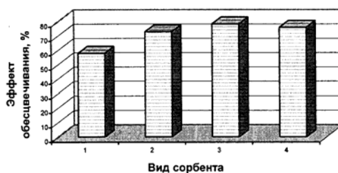
Рис. 1. Влияние модификации неорганического адсорбента на эффект обесцвечивания сахаросодержащего раствора:
