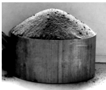
Рис. 2. Снимок конуса сыпучего материала
