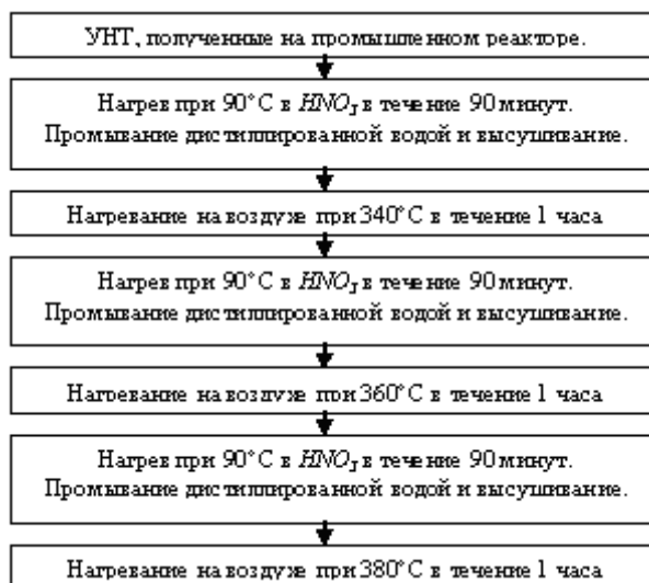
Рис. 1. Схема очистки УНТ от катализатора и аморфного углерода
