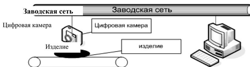
Рис. 1. Принципиальная схема интеллектуального датчика показателей качества хлебобулочных изделий
