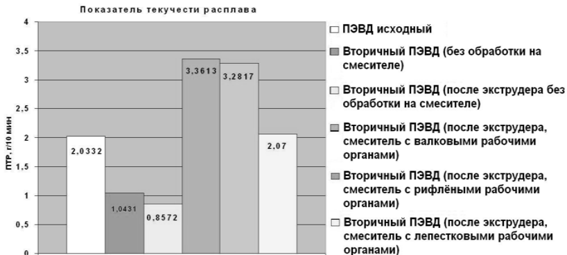
Рис. 4. Сравнительная характеристика воздействия различных рабочих органов на вторичный материал
