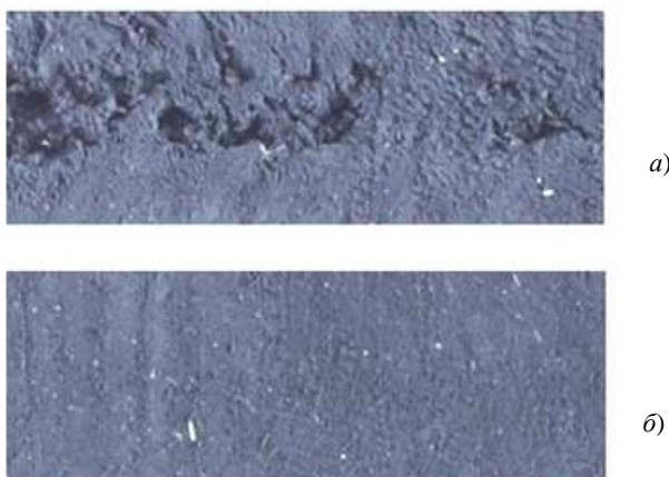
Рис. 1. Фотографии поперечных сечений переработанной резиновой крошки без воздействия ультразвука ( а ) и с его применением ( б )
