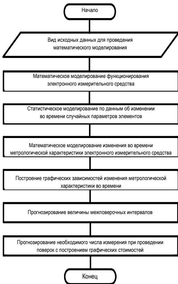
Рис. 1. Блок-схема алгоритма оценки метрологической надежности на этапе проектирования
