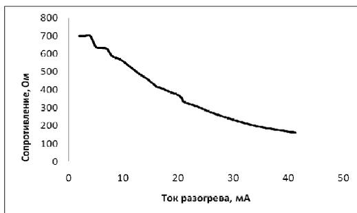
**Рис. 2. Характеристика нагрева терморезистора М1К0 прямым подогревом**
