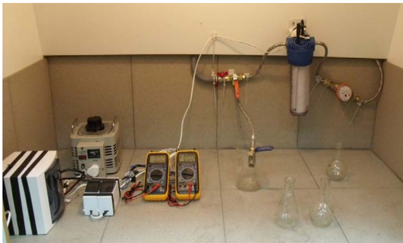
Рис. 1. Экспериментальная установка кондиционирования воды
