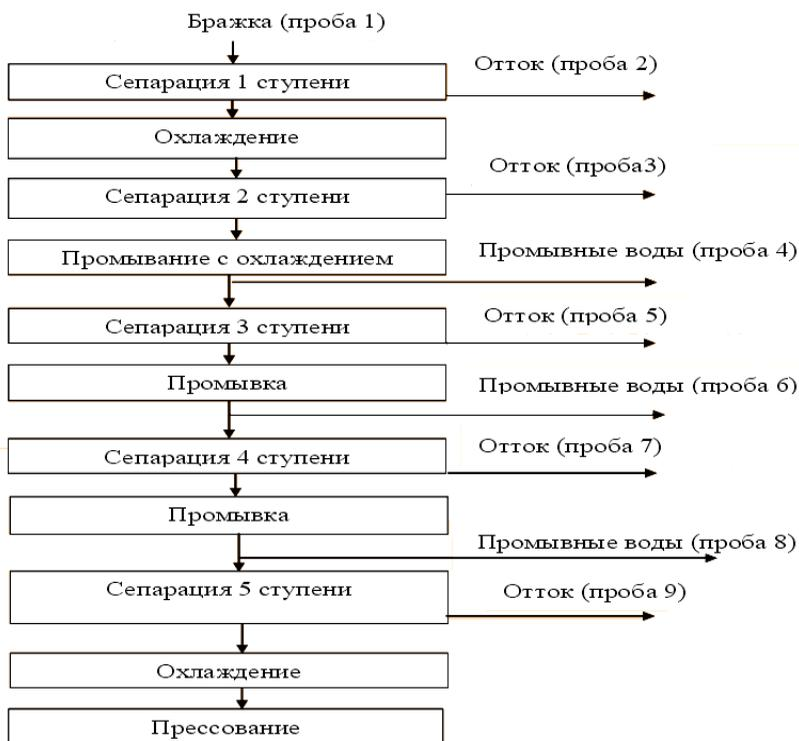
Рис. 1. Схема отбора проб на участке сепарации бражки
