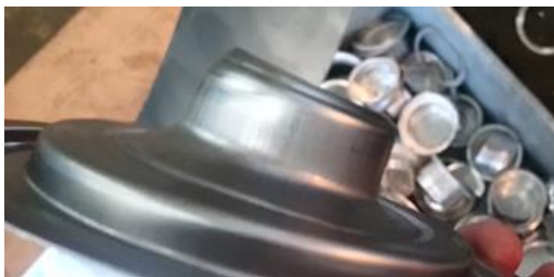
Рис. 5. Последствия неправильной установки детали в штамп
