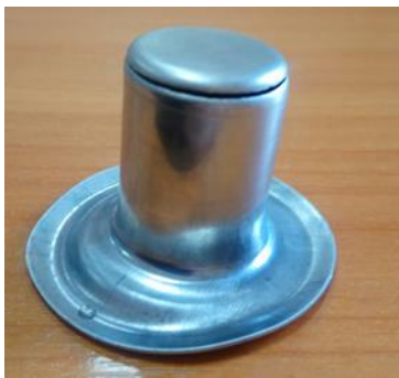
Рис. 2. Надрыв металла при вытяжке из-за сильного прижима заготовки
