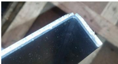
Рис. 1. Разрыв металла в местах гибки
