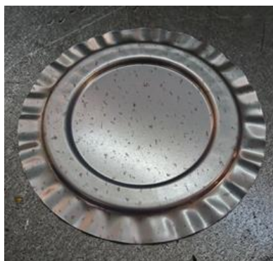
Рис. 4. Деталь с пропущенной операцией калибровки
