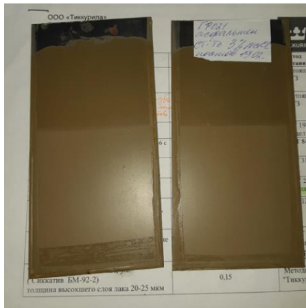
Рис. 1. Стойкость пленки к статическому воздействию 3 %-ного раствора хлорида натрия
