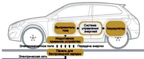
Рис. 1. Схема беспроводной зарядки для электротранспорта
