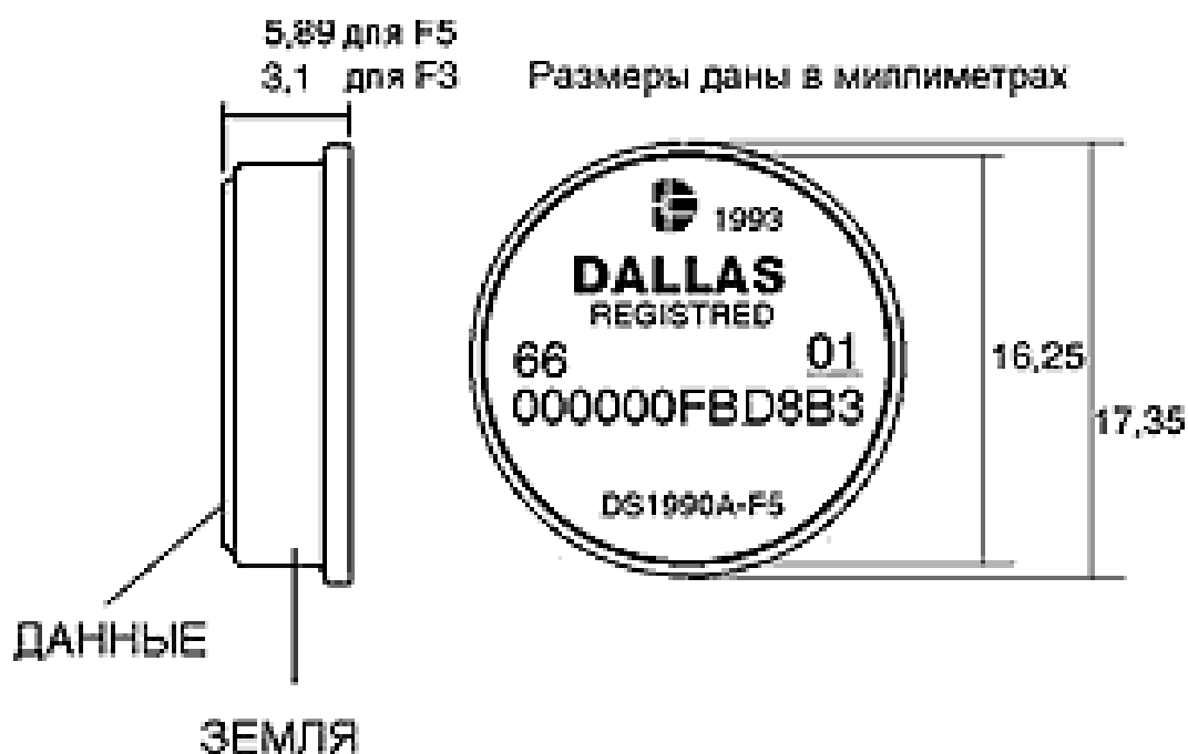
Рис. 4.1. Электронный ключ-идентификатор iButton
