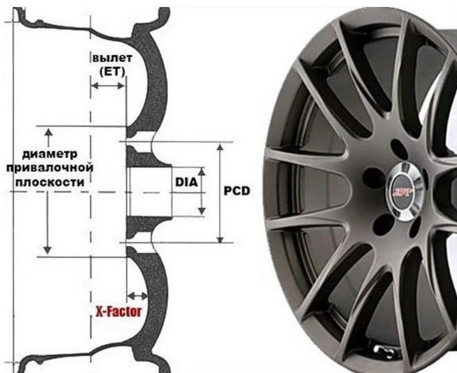
Рис. 4.2. X-factor – расстояние между привалочной плоскостью и задней стороной диска
