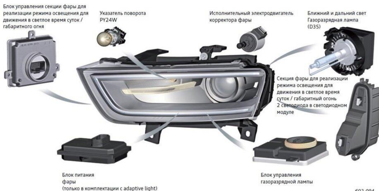
Рис. 3.1. Устройство ксеноновой фары
