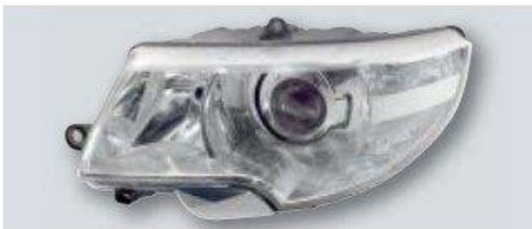
Рис. 3.3. Вид рассеивателя фары с прозрачным покрытием
