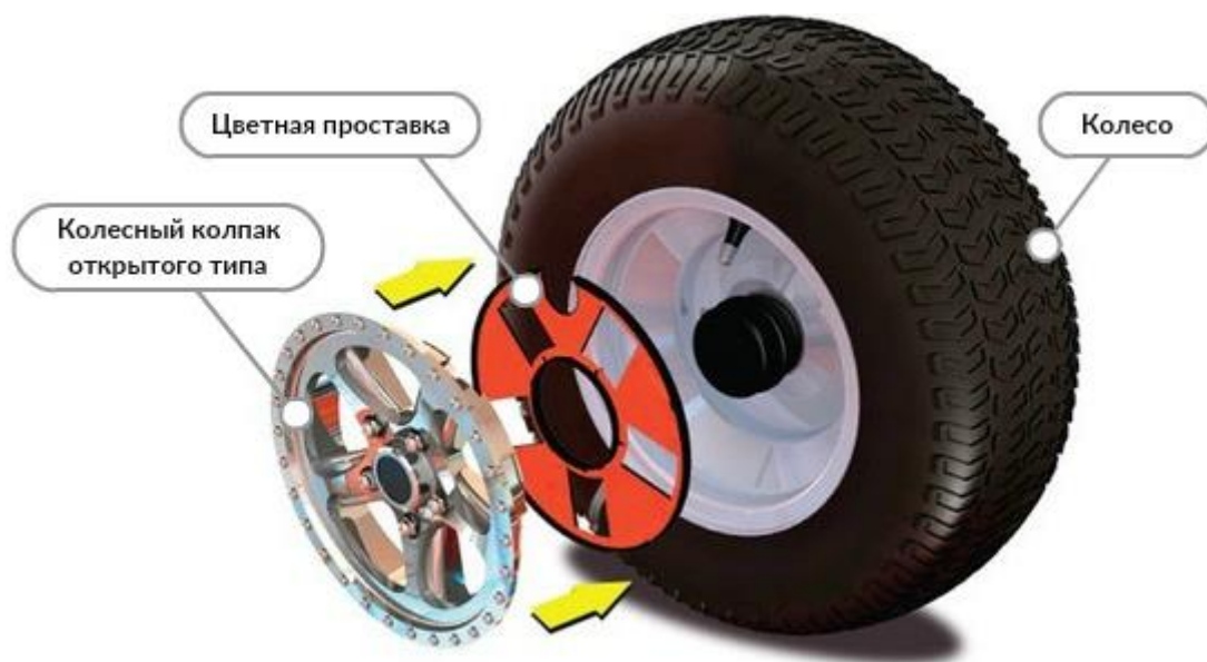
Рис. 4.5. Колесный колпак открытого типа с цветными проставками
