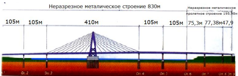
Рис. Б.2. Схема Живописного (вантового) моста через Москву-реку
