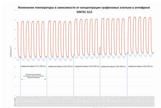
Рис. 2. Изменение температуры в зависимости от концентрации графеновых хлопьев в антифризе Sintec G12.
