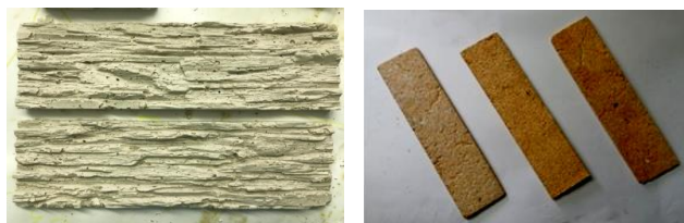
Рис. 1. Декоративные плитки: 270×85×15 мм (а), 220×55×5 мм (б)
