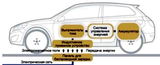
Рис. 1. Схема беспроводной зарядки для электротранспорта
