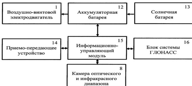
**Рис. 3.** Схема электропитания, управления, сбора и передачи информации
