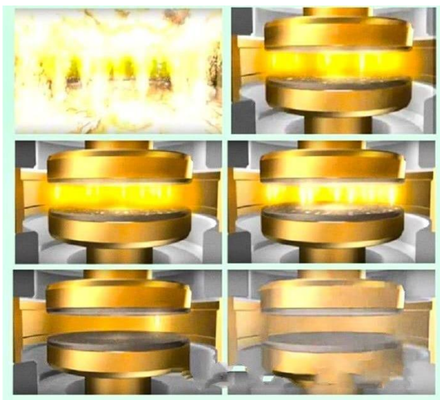
Рис. 23. Электрическая дуга в вакуумном выключателе, фаза 2
