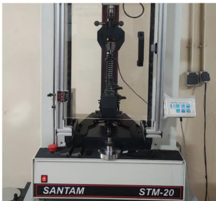
Рис. 2. Испытание пружины растяжения на одноосное растяжение
