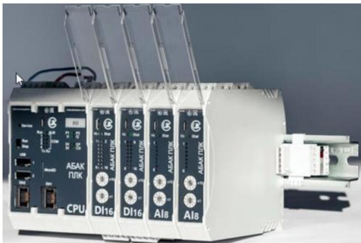
Рис. 9.2. Контроллер АБАК ПЛК исполнения К2
