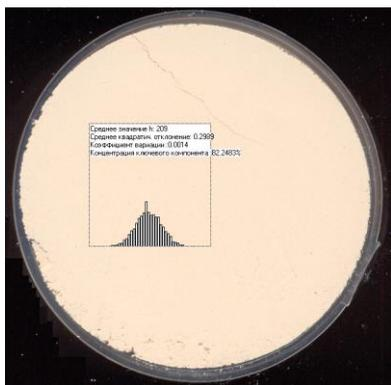
Рис. 4. Определение состава и качества реальной смеси цеолит-бентонит
