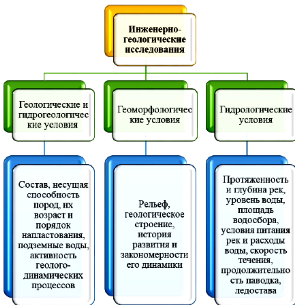
Рис. 11. Виды инженерно-геологических исследований для градостроительного освоения территории
