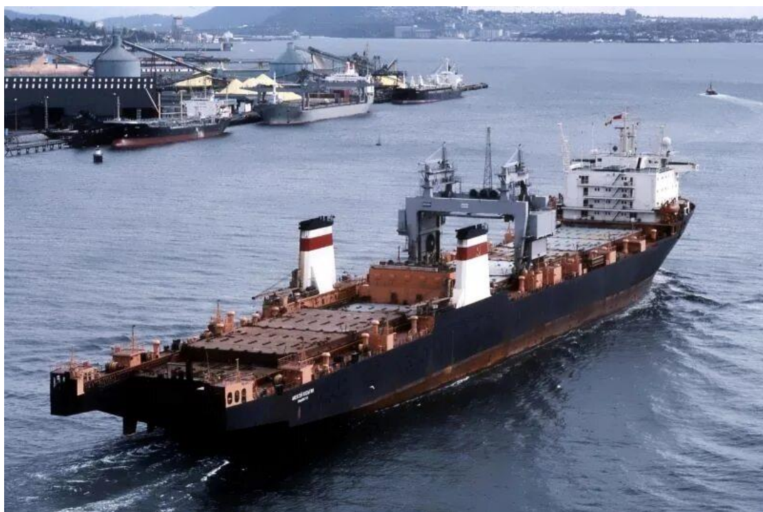
Рис. 4. Лихтерная перевозка: а – лихтер; б – лихтеровоз
