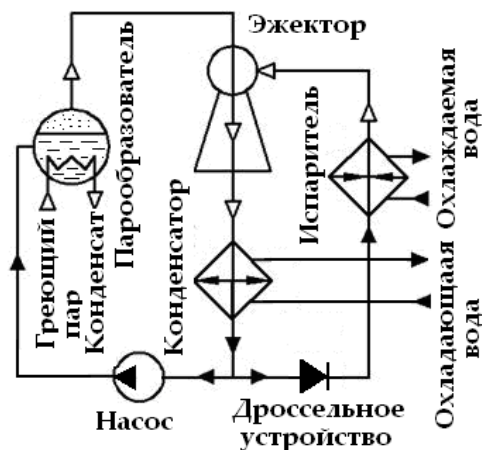
Рис. 6.1. Схема струйного (эжекторного) трансформатора теплоты
