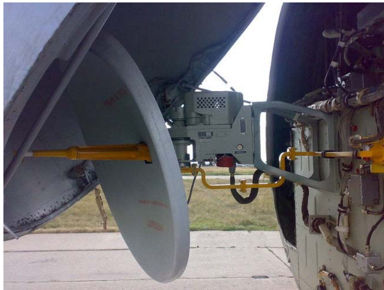
Рис. 20. Антенный блок БРЛС Гроза; размещен под носовым обтекателем фюзеляжа АН-26 (шпангоут 1А).
