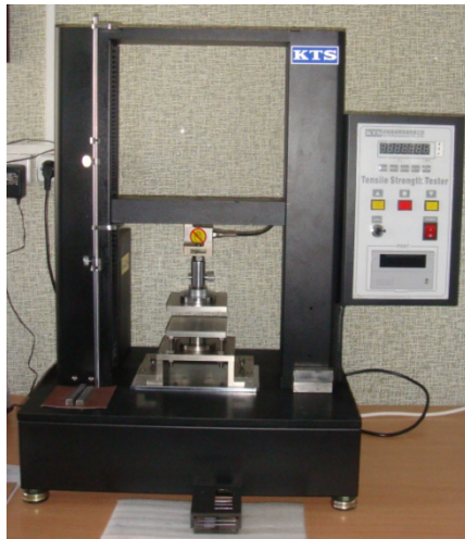
Рис. 6.4, Машина для определения сопротивления продавливанию KTS-300.
