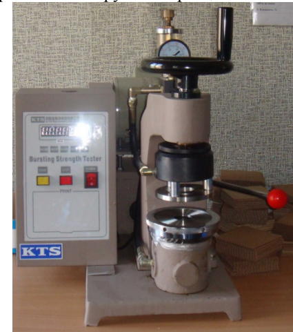
Рис. 1. Машина для определения сопротивления продавливанию KTS-300.
