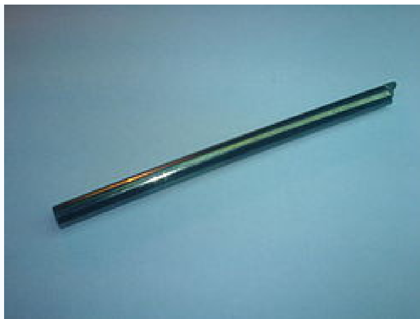
Рис. 24. Монокристалл теллурида висмута
