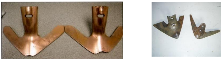
Рис. 1.3. Износ носовой части стрельчатых лап
