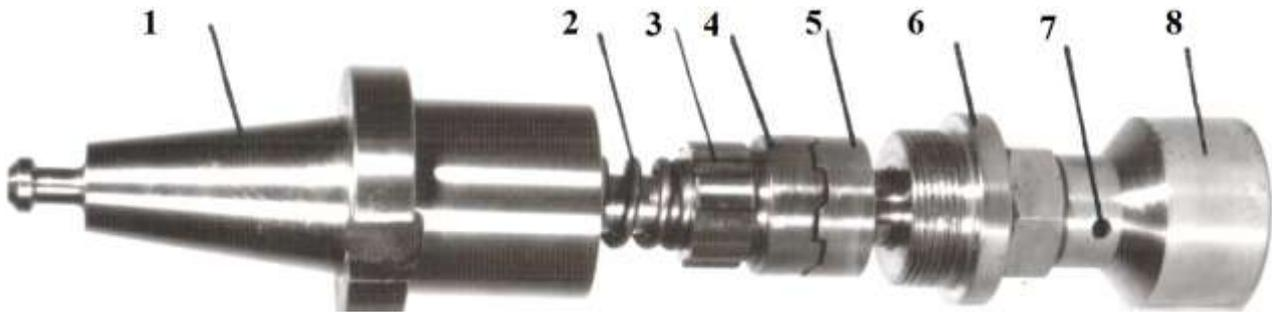
**Рис. 4 Оправка-ключ для автоматического базирования заготовки в приспособлении станка МС 12-250**
