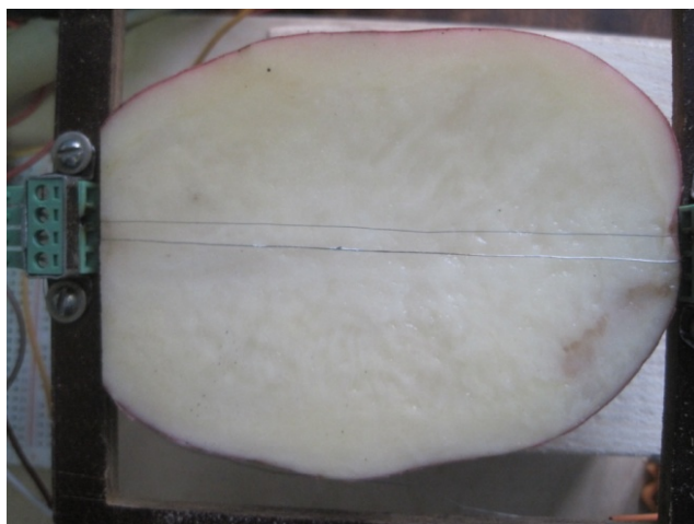
Рис. 2. Размещение термопреобразователя и нагревателя на растительной ткани клубня
