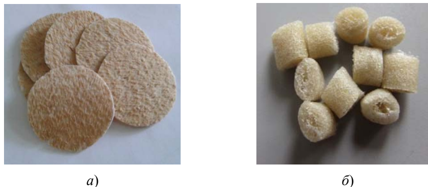
Рис. 1. Образцы композитной биоагрузки состава «ПЭ : ПС» в виде дисков (а) и гранул (б)
