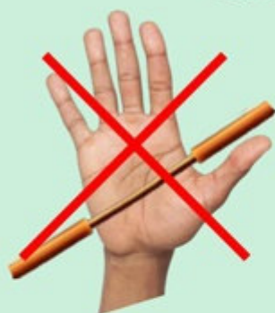
Оголенная изоляция проводов
