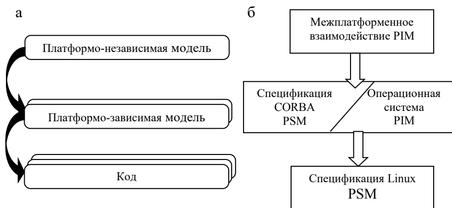
Рис.3.2. Преобразования моделей: а – последовательность преобразования моделей, б – межплатфо-форменные преобразования
